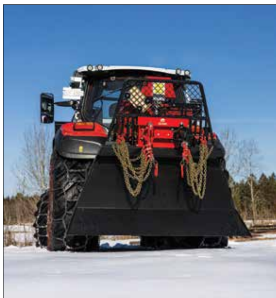
Sort port viser pullmatic som gjør jobben med å dra ut vaieren ut til en lek
